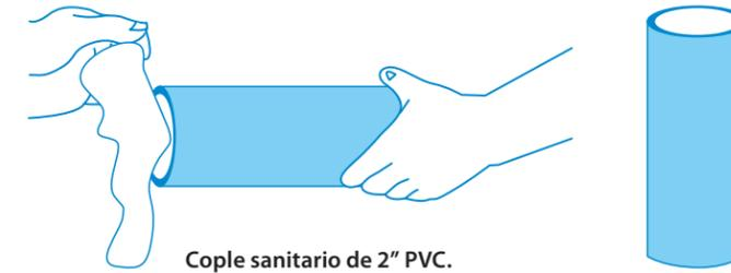
12. Coloque el adaptador macho de 2"x2" pegar en la salida de agua tratada. Posteriormente únalo con el cople sanitario 2" de PVC. Limpie el extremo del tubo sanitario de 2" de PVC y únalo al otro extremo libre del cople sanitario 2" de PVC. El tubo de 2" de PVC va dirigido al pozo de absorción o zanja de infiltración.
