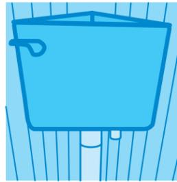
10. Enrosque el conector hembra al tanque y pegue con cemento (PVC) el extremo del tubo de 2" al conector hembra.
